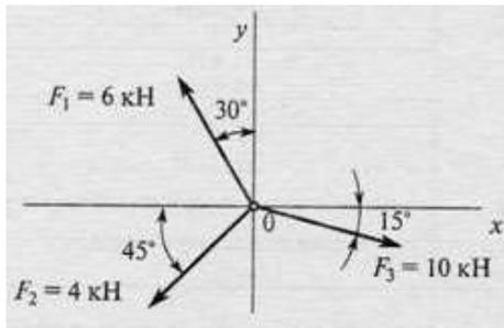
Определить проекцию равнодействующей на ось  $x$ .
