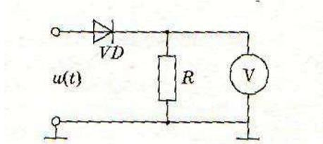
Рисунок 2 – Схема  $VD - R$ -цепи
