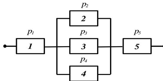
8) Рис. 1. Схема для вычисления надёжности системы
