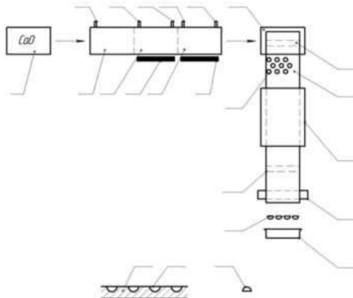
Технологическая схема получения хемосорбента в виде полусфер
