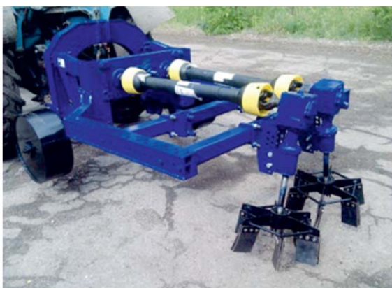
Рисунок 3 - Модуль для весеннего раскрытия маточника УКМ-ВР
