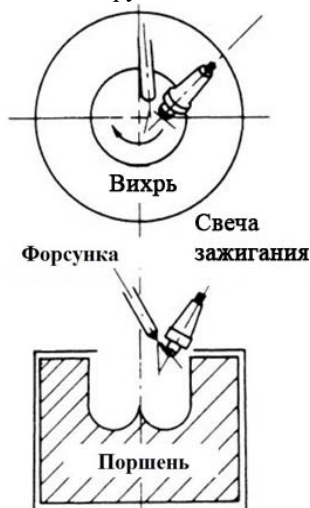
Рисунок 8 – Схема рабочего процесса TCCS фирмы Техасо
