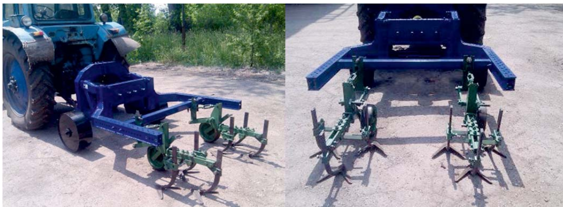
Рисунок 4 - Модуль для междурядной обработки УКМ-МО
