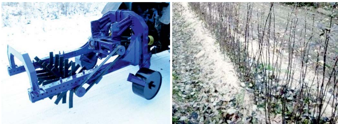
Рисунок 7 - Модуль для удаление и листвы УКМ-ОЛ
