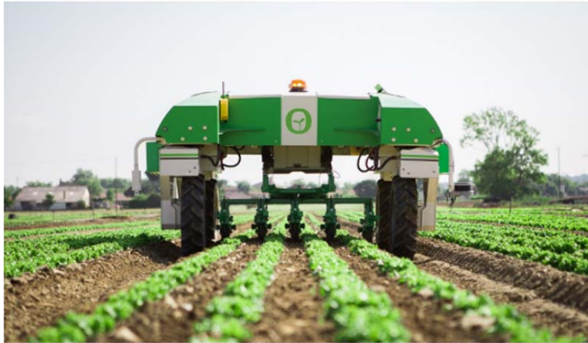
Рисунок 2 – Автономный робот для прополки «Unkrautbekämpfung»
