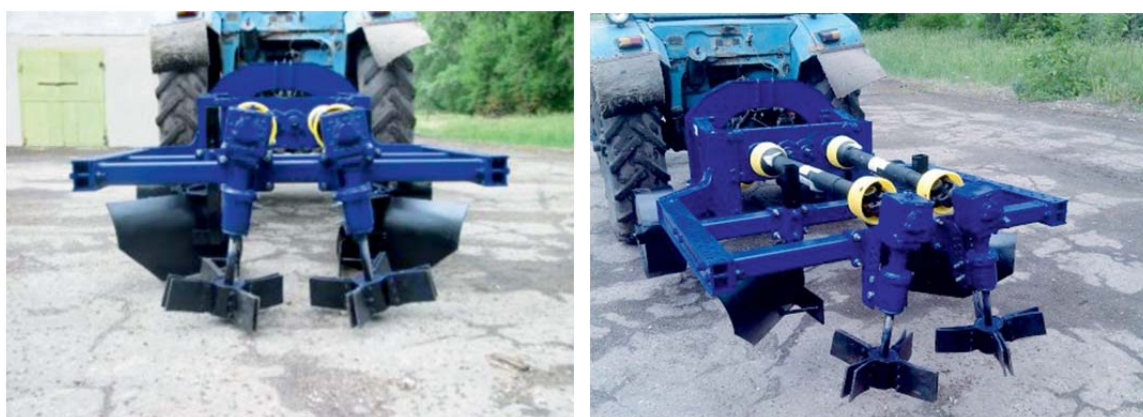
Рисунок 6 - Модуль для удаления субстрата укрывного вала УКМ-ПК
