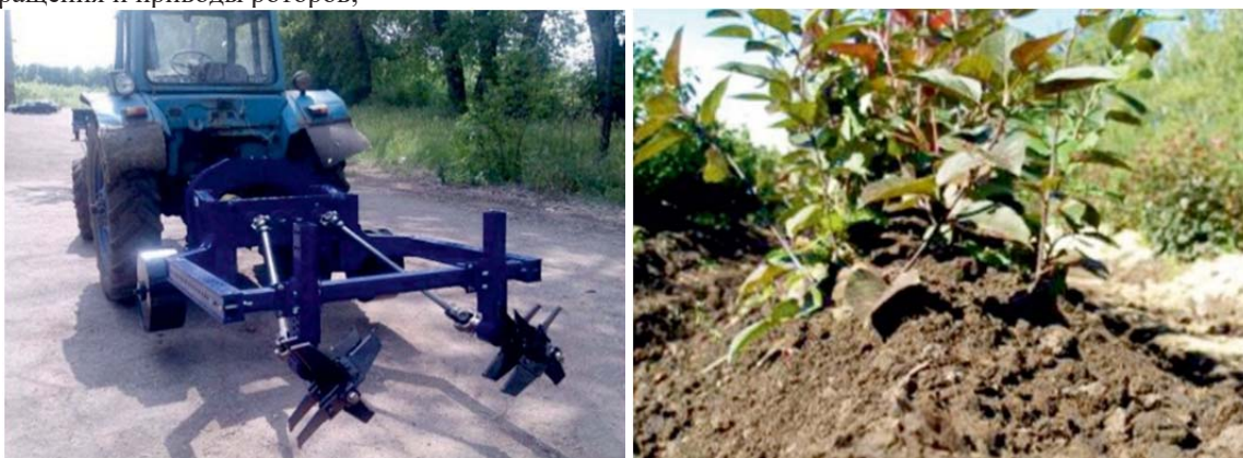
Рисунок 5 - Модуль для окучивания отрастающих побегов УКМ-О
