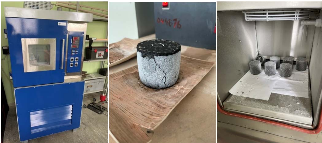
Рисунок 1 - Подготовительный период испытания кернов на прочность.
