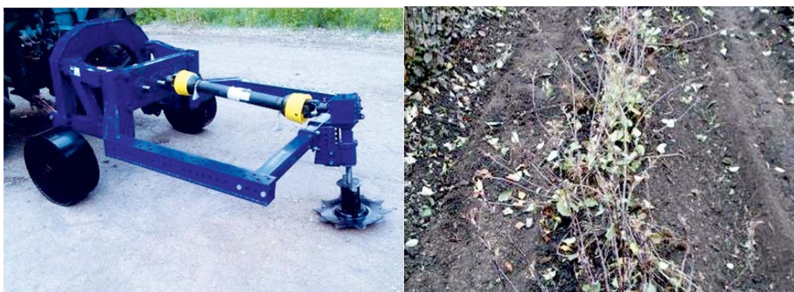
Рисунок 8 - Модуль для отделения отводков УКМ-МО
