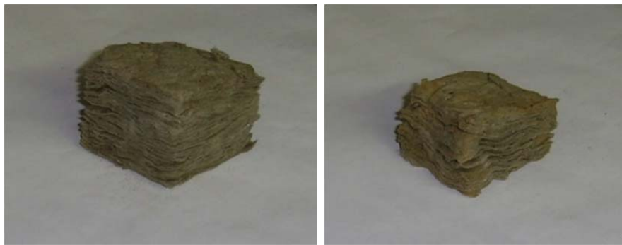
Рисунок 2 – Образцы после 5 циклов (а) и 30 циклов (б) замораживания и оттаивания
