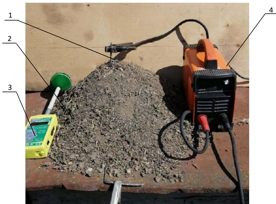
1 - электрод, 2 – куриный помет, 3 – прибор контроля параметров электрического поля (ПЗ-41), 4 – источник постоянного тока (AV971122).
