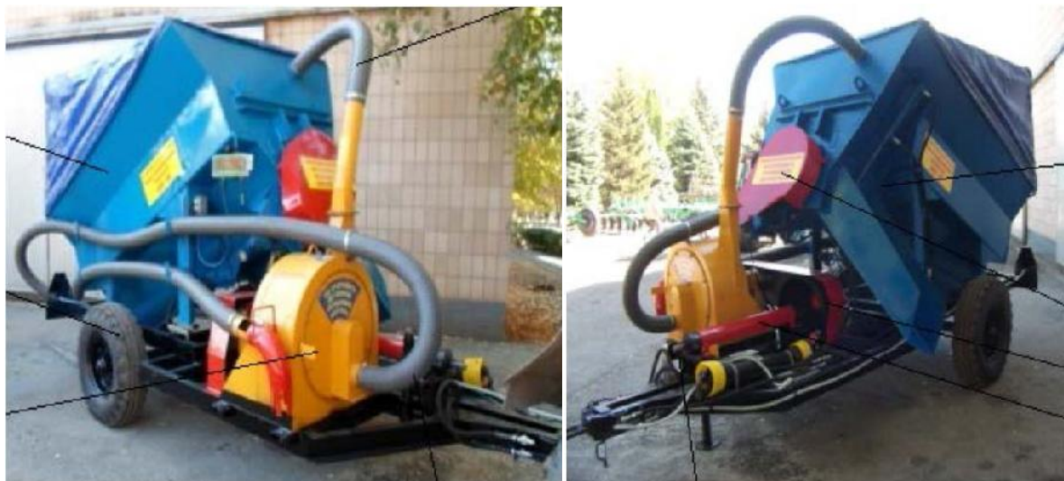
1 – смеситель; 2 – ходовая часть; 3 – выгрузное окно с заслонкой и скатным лотком; 4 – привод смесителя; 5 – дробилка зерна; 6 – контрпривод; 7 – клиноременная передача; 8 – карданный вал; 9 – всасывающий рукав; 10 – нагнетательный трубопровод Рисунок 6 - Агрегат комбикормовый мобильный АКМ-3М
