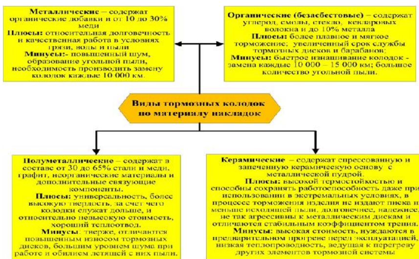
Рисунок 1 - Виды тормозных колодок по материалу накладок
