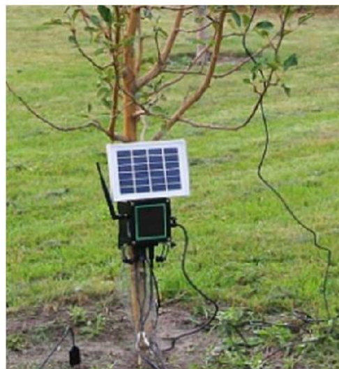
Рисунок 1 – Фото подключения узла Smart Agriculture к датчикам
