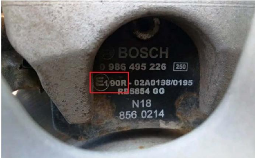
Рисунок 3 - Пример нанесения маркировки соответствия тормозных колодок ECE R-90
