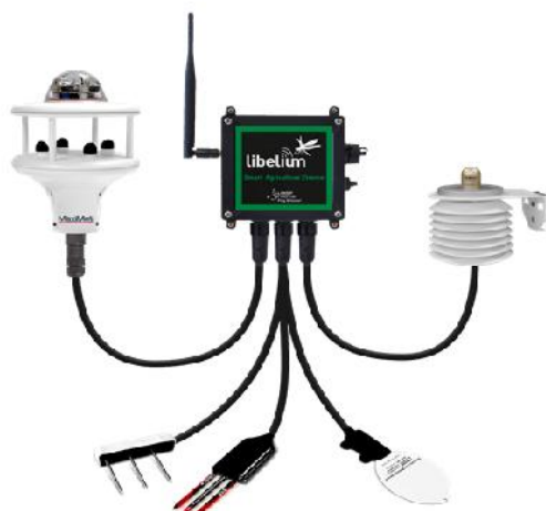
Рисунок 1 – Фото подключения узла Smart Agriculture к датчикам
