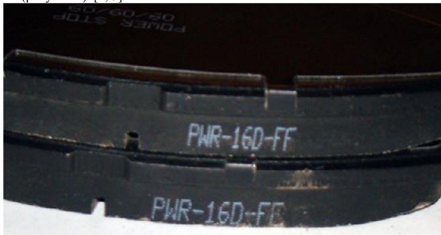
Рисунок 2 - Пример маркировки тормозных колодок
