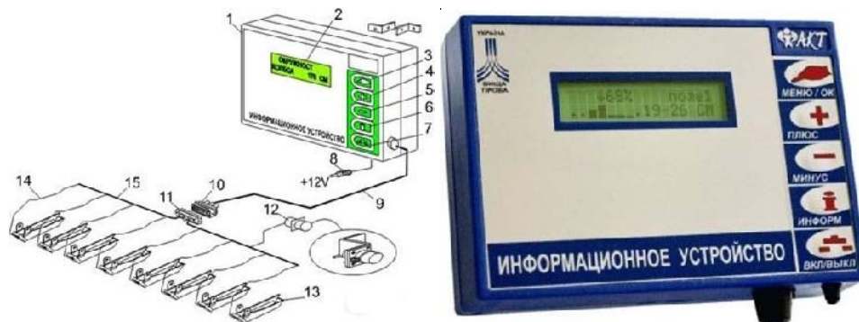
1 - корпус монитора; 2 - информационное табло; 3 - кнопка “меню”; 4 - кнопка “плюс”; 5 - кнопка “минус”; 6 - кнопка “информ”; 7 - кнопка “вкл/выкл”; 8 - штекер “12В”; 9 – кабель; 10 - розетка; 11 - вилка; 12 - датчик пути; 13 - датчик высева; 14 – кабель датчика высева; 15 - кабельная разводка по сеялке.
