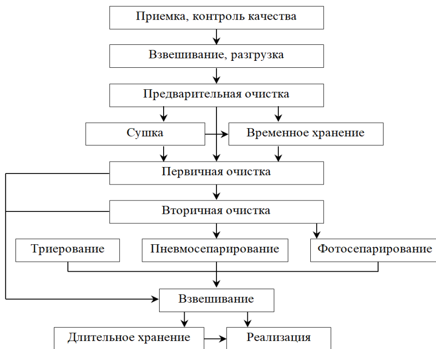
Рисунок 1 – Схема технологического процесса обработки зерна и семян
