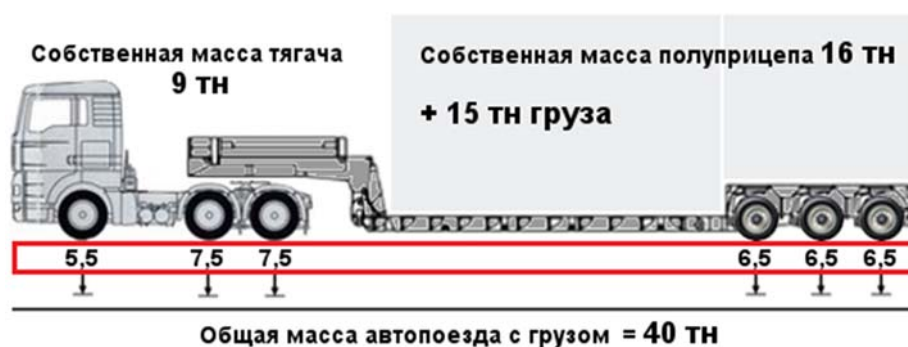
Рисунок 2 - Схема распределения общей массы автопоезда специального назначения с грузом по осям
