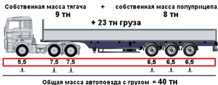
Рисунок 1 - Схема распределения массы автопоезда общего назначения с грузом по осям
