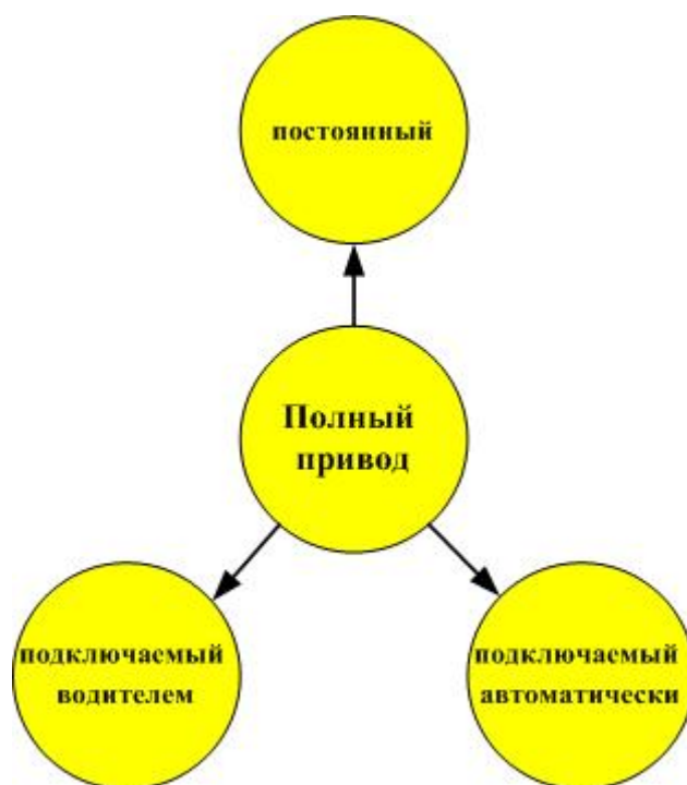
Рисунок 1. Схемы трансмиссий полноприводных автомобилей
