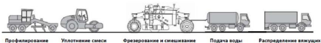
Рисунок 3 – Технологическая схема укрепления грунтов
