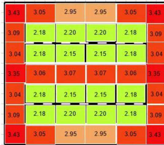
Рисунок 2 – Карта распределения длин свободного пробега при зеркальном отражении звука от ограждений (ячейки замкнуты)
