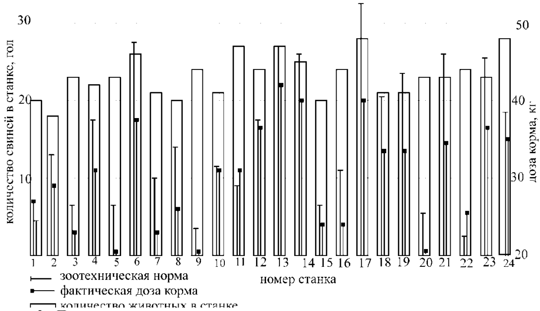
Рисунок 2 – Показатели раздачи корма в ручном режиме кормораздатчиком со шнековым дозирующим органом
