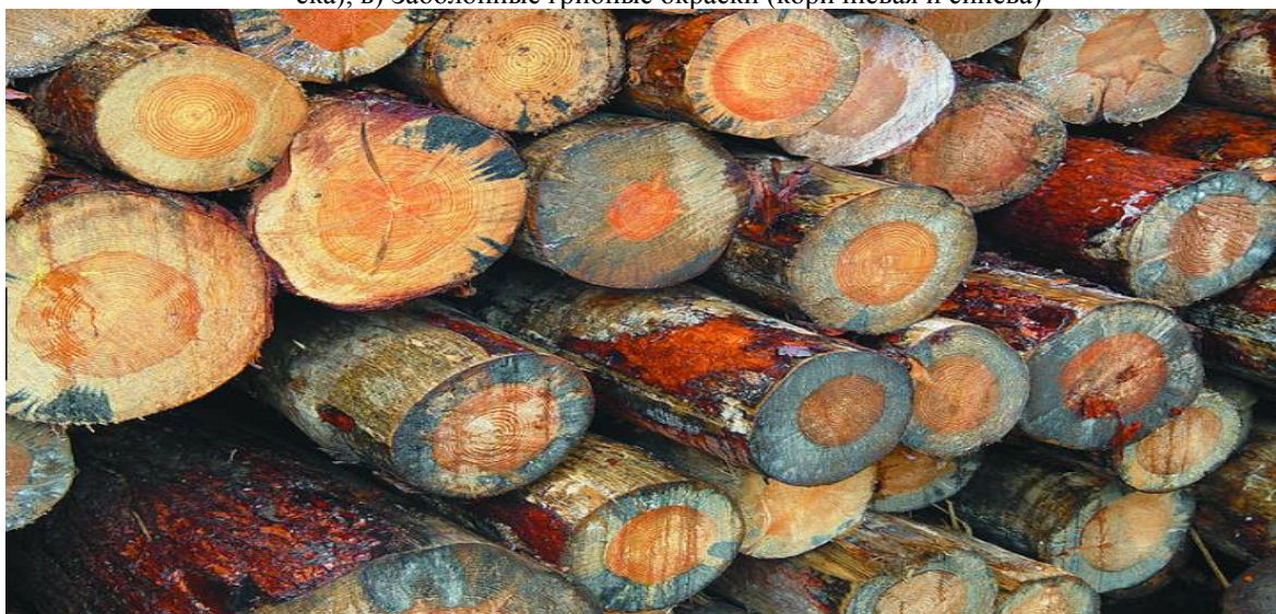
Рисунок 2 – Изменение окраски брёвен под действием деревоокрашивающих грибов
