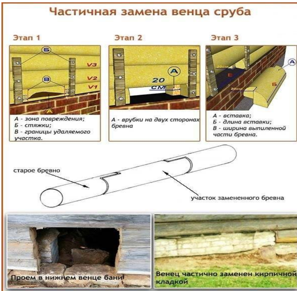
Рисунок 1 – Частичная замена венца сруба
