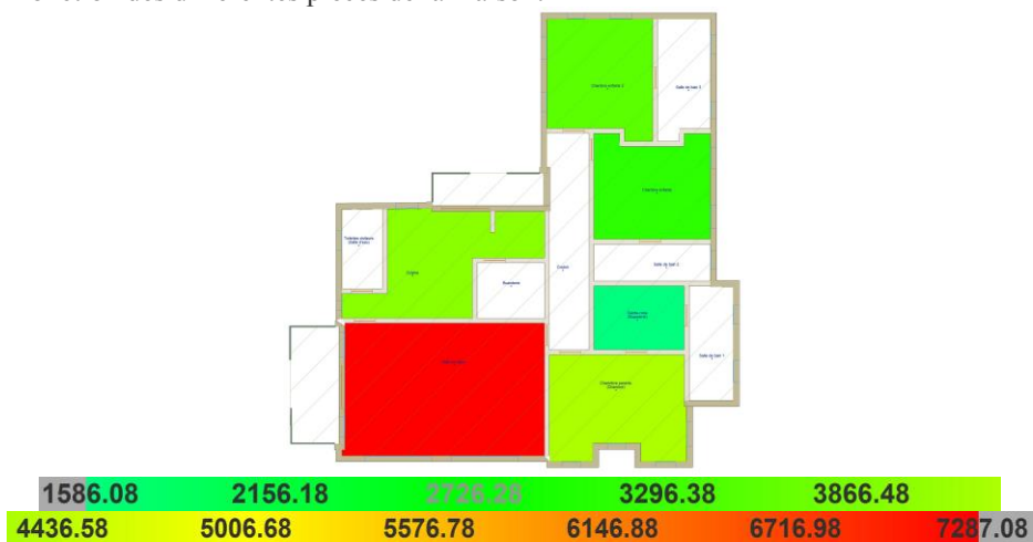
Figure 3 – Charge thermique totale de refroidissement (W) pour les blocs de béton
