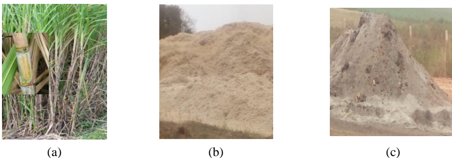
Figure 2. (a) - Champ de canne à sucre. (b) - bagasse issue du broyage de la canne à sucre, (c) - cendre de bagasse à la sortie du four
