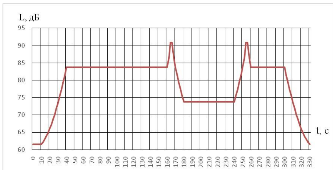
Рисунок 3 – График шумового воздействия на оператора (вариант 2)
