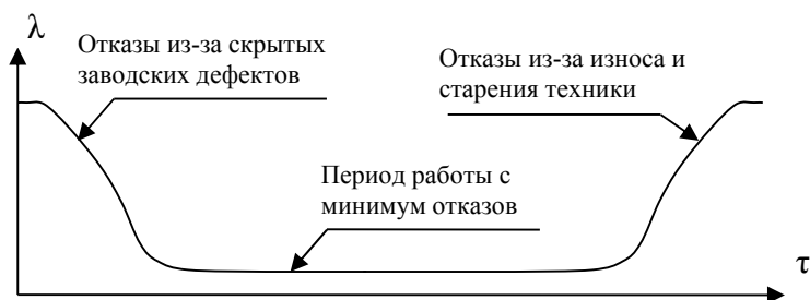
Рис. 2. Типичный закон изменения интенсивности \lambda отказов от времени \tau эксплуатации техники
