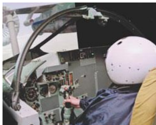
Рисунок 4. Процедурный авиационный тренажёр обучения лётчика дозаправке в воздухе с двухканальным 3D-индикатором с диспаратными очками
