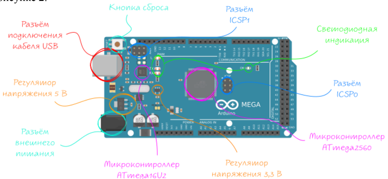
Рисунок 2. Элементы платы Arduino.
