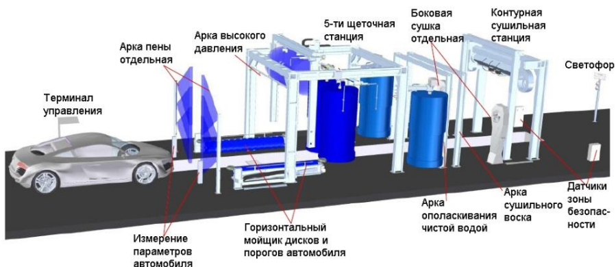
Рис. 12. Туннельная мойка Washtec SL2 Compact (14,49 м)
