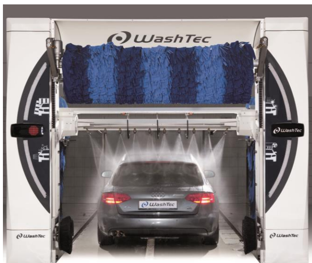
Рис. 10. Комбинированная порталная мойка SoftCare 2 Pro Touchless
