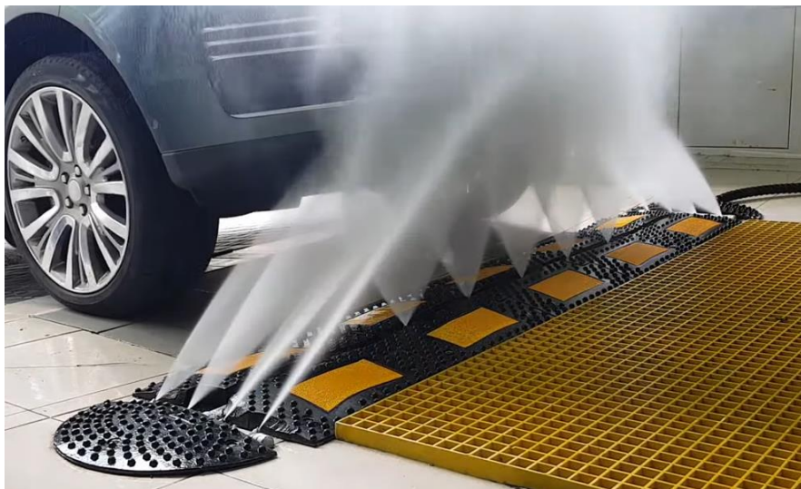
Рис. 16. Трубчатая неподвижная моющая рамка на въезде в помещение мойки
