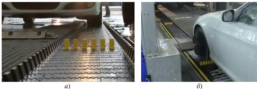
Рис. 31. Упоры толкающего конвейера туннельной мойки фирмы «Christ Wash Systems»:
