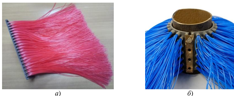
Рис. 24. Внешний вид и способ крепления щеточного элемента для моечных установок ПМУ-1:
