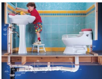
Рис. 1.8. Приемники бытовых сточных вод
