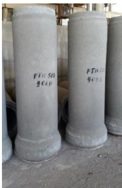
Рис. 3.2. Железобетонные трубы для канализации
