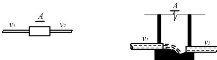
Рис. 2.16. Гашения скорости в перепадном колодце:
