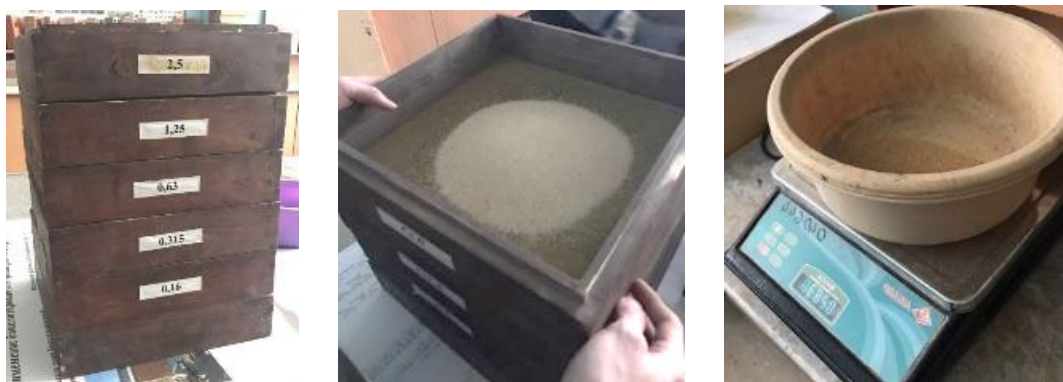
Рис. 3. Стандартный набор сит и проведение испытания
