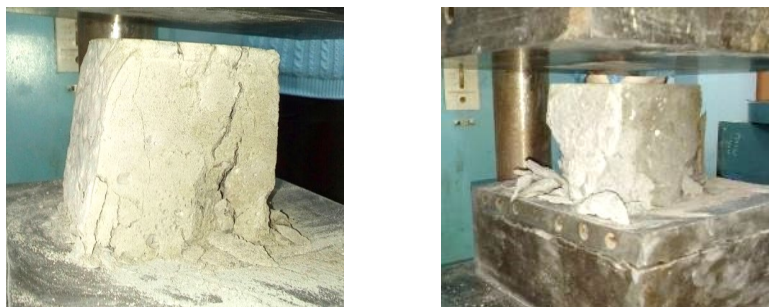
Рис. 35. Виды разрушения образцов бетона при сжатии
