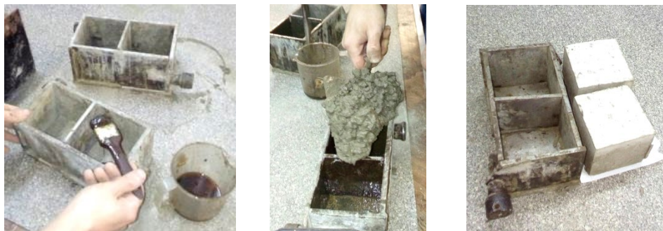
Рис. 34. Изготовление образцов бетона
