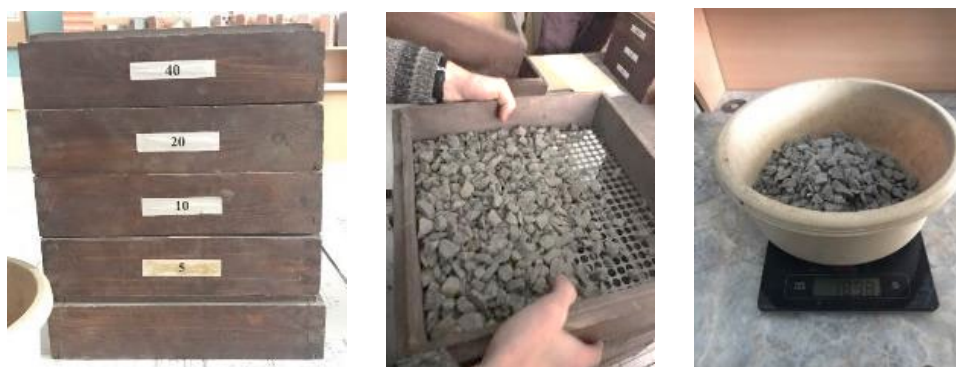
Рис. 5. Стандартный набор сит и проведение испытания
