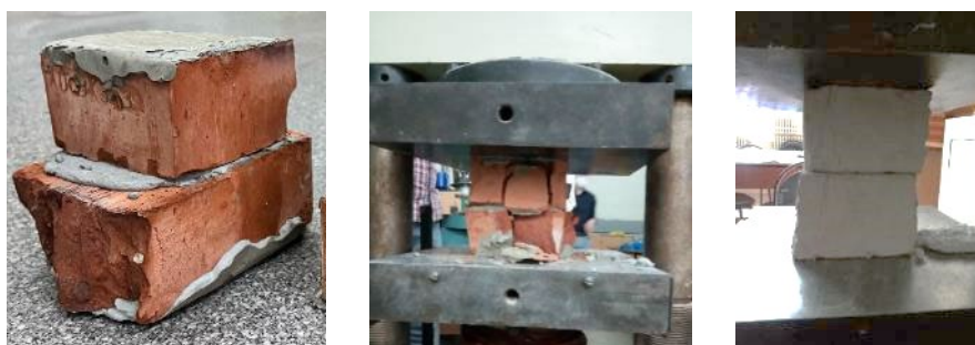
Рис. 9. Образцы и схема испытания кирпичей на сжатие
