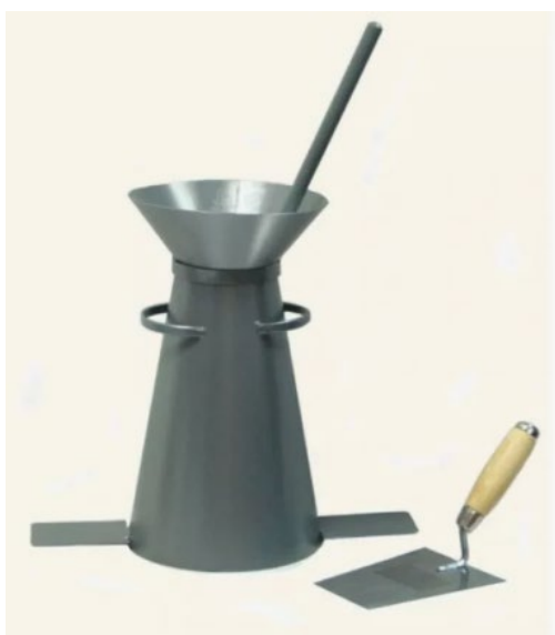
Рис. 31. Приборы для определения подвижности (а) и жесткости (б) бетонной смеси
