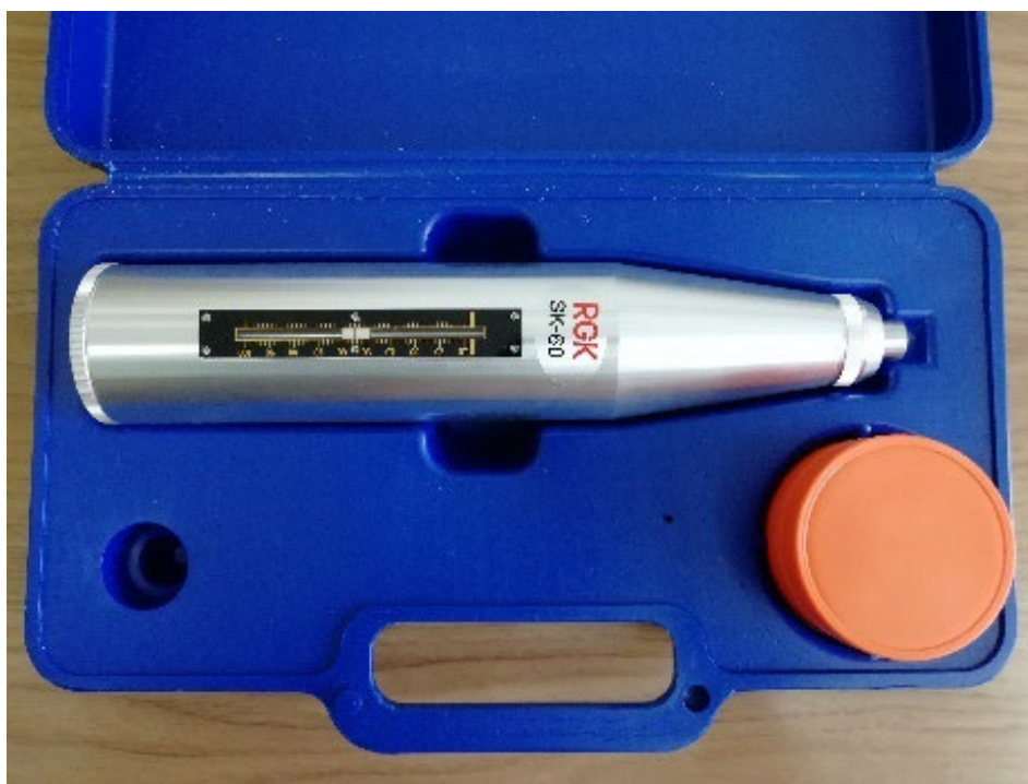
Рис. 40. Склерометр RGK SK-60
