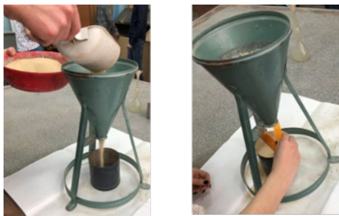
Рис. 1. Определение насыпной плотности песка
