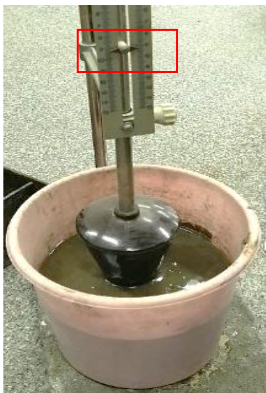
Рис. 20. Определение глубины погружения конуса
