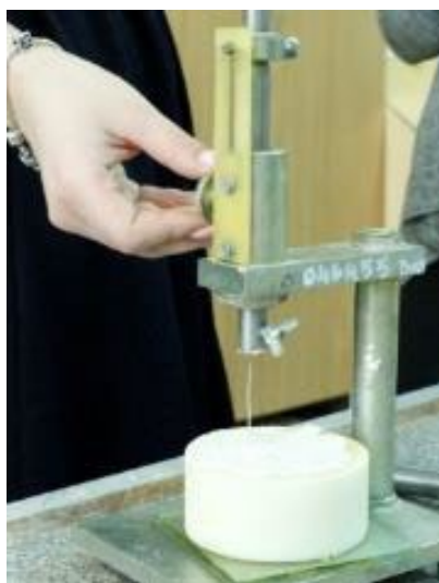
Рис. 13. Установка иглы прибора на поверхность гипсового теста
