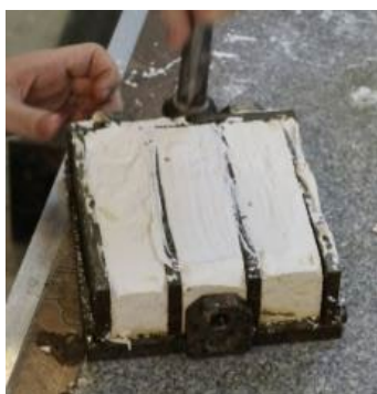
Рис. 15. Извлечение образцов-балочек из формы
