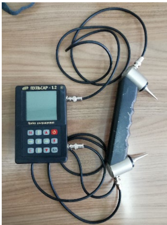
Рис. 41. Пульсар – 1.2 с датчиком для поверхностного прозвучивания
