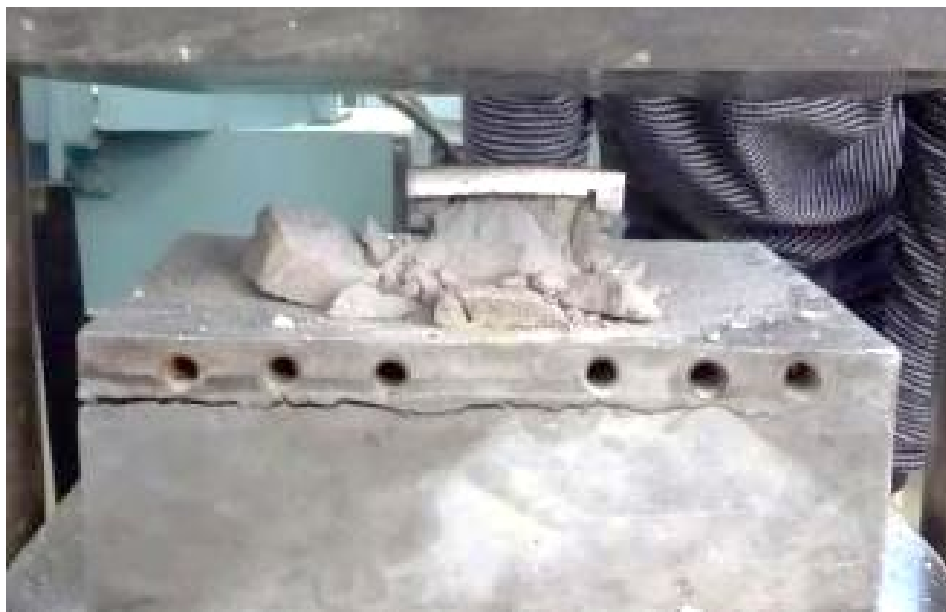
Рис. 24. Разрушение образцов строительного раствора при сжатии
