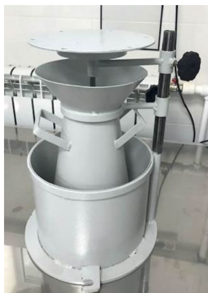
Рис. 31. Приборы для определения подвижности (а) и жесткости (б) бетонной смеси
