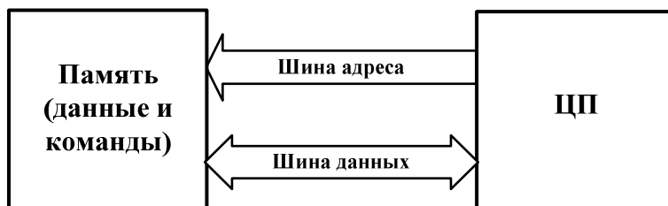
Рис. 2.9. Архитектура фон Неймана (один модуль памяти)
