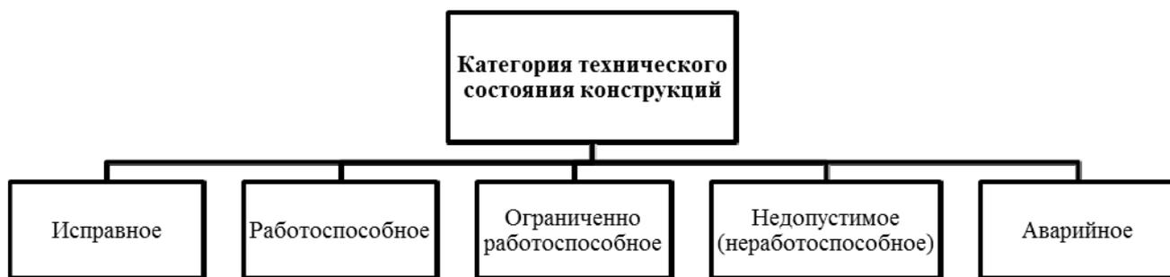
Рисунок 28 – Категории технического состояния конструкций
