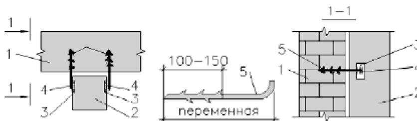
Рисунок 38 – Восстановление сопряжений гибкими связями: 1 - продольная стена, 2- железобетонная колонна, 3 - закладная деталь колонны, 4 - сварка, 5 – анкер
