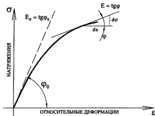
Рисунок 7 – Зависимость между напряжениями и деформациями каменной кладки при сжатии
