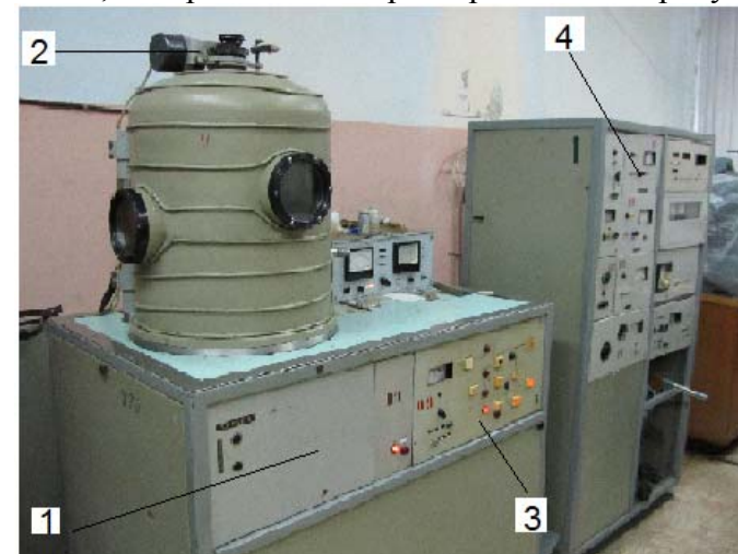
Рисунок 3 Универсальный вакуумный напылитель марки УВН 71П-1:
