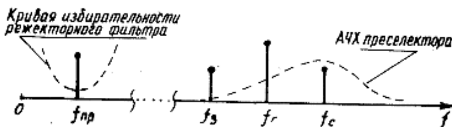
Рис. 2.6. Подавление помехи и выделение полезного сигнала на промежуточной частоте
