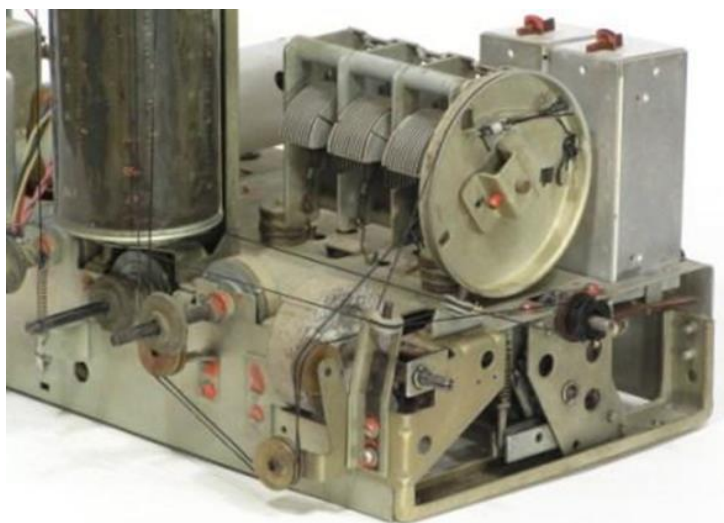
Рис. 3.21. Применение конденсаторов переменной емкости для плавной перестройки
