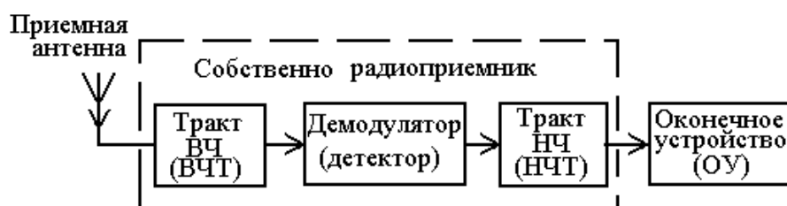
Рис. 1.1. Обобщенная структурная схема РПУ
