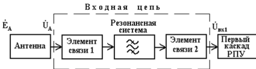
Рис. 3.1. Состав и расположение ВЦ в приемном устройстве
