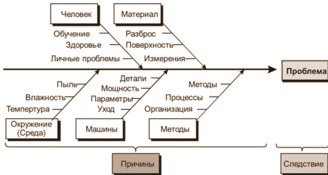
Рис. 5. Схематический вид причинно-следственной диаграммы Исикавы
