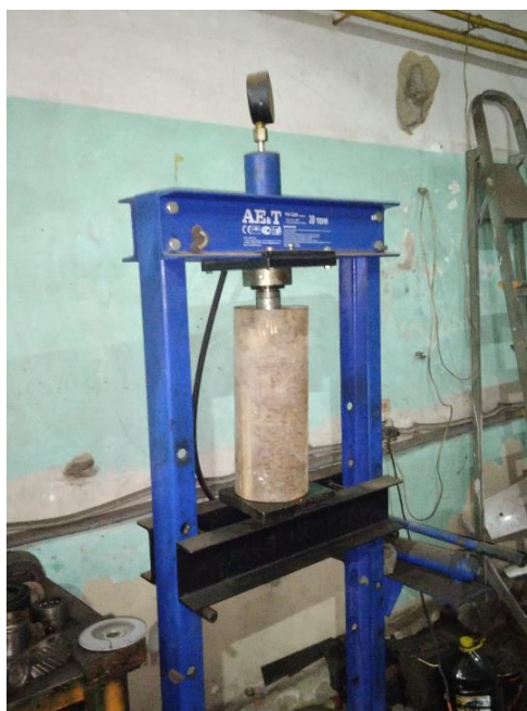
Рис. 2. Пресс-форма в виде цилиндра
