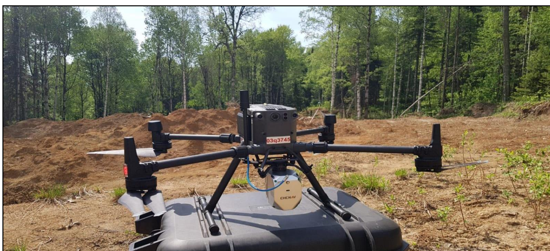
Рис. 2. Сканер СНС АА450, установленный на квадрокоптере Matrice 300
