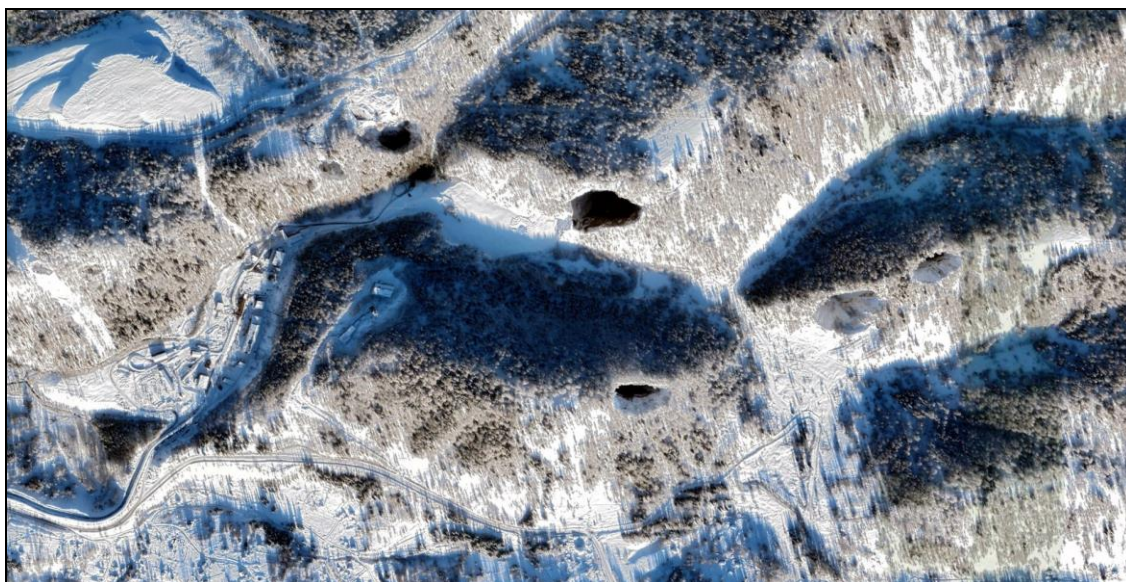
Рис. 1. Фрагмент расположения нарушенной территории с провалами земной поверхности
