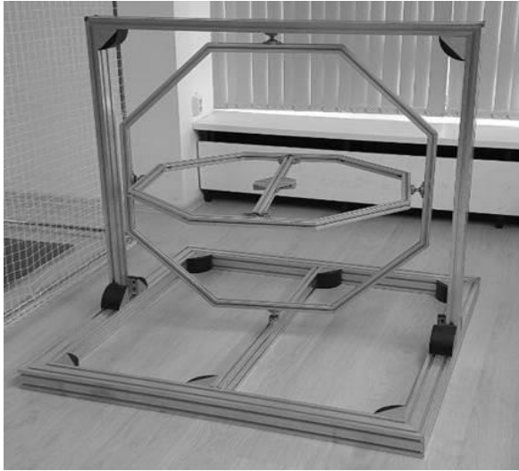
Рис. 1. Гироскопический испытательный стенд (слева); стендовая подвижная система координат (справа)
