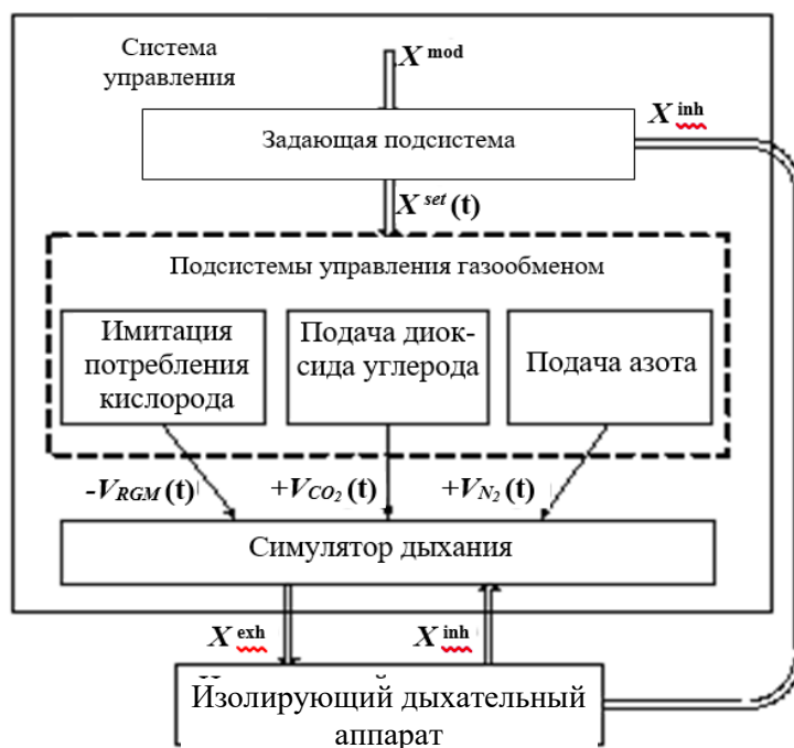
Рис. 2. Структура системы управления «СД-ИДА»
