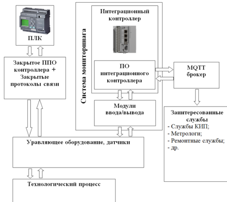
Рис. 7. Функциональная схема системы мониторинга при закрытом ППО контроллера и закрытыми протоколами связи
