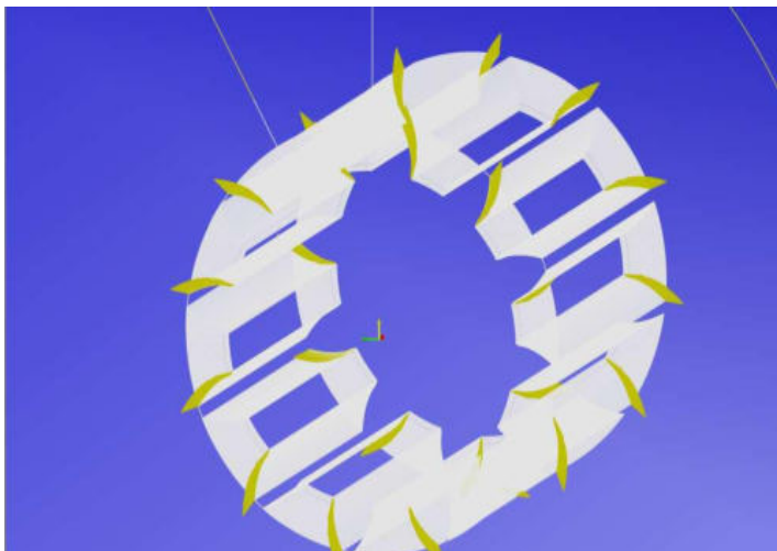
Рис. 1. Траектории движения инструмента при обработке по программе-шаблону
