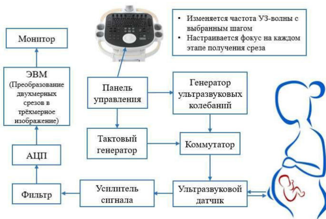
Рис. 1. Принципиальная схема получения томограммы УЗИ для дальнейшего преобразования в трёхмерном виде
