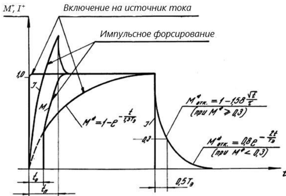
Рис. 1. Механическая характеристика быстродействующей муфты при включении и отключении
