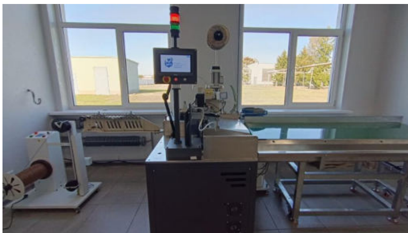
Рис. 5. Опытный образец программно-аппаратного комплекса по изготовлению жгутов автотранспортного назначения
