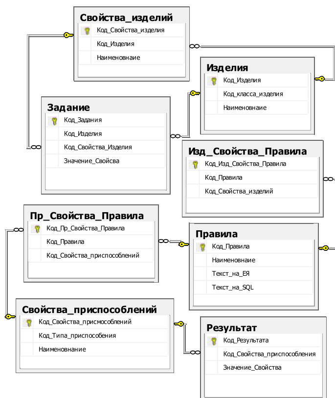
Рис. 3. Схема реляционной базы данных для выбора приспособлений, необходимых для изготовления элементов технологического оборудования
