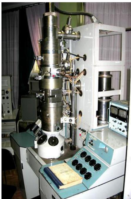
**Рис. 2.8. Электронный микроскоп ПЭМ 125-К**
