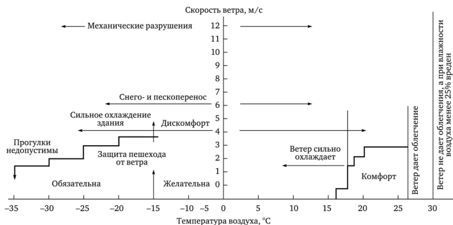
Рис. 5. Диаграмма комплексного воздействия ветра и температуры на человека и здания во внешней среде
