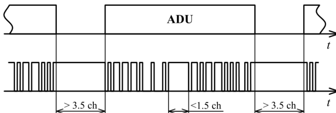
Рис. 2.5. Передача данных Modbus RTU
