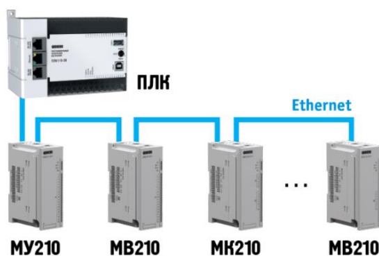
Рис. 3.11. Пример использования модулей ввода-вывода Mx210
