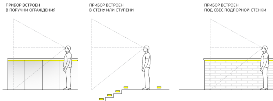
Рис. 24. Схемы устройства освещения, не препятствующего движению посетителей
