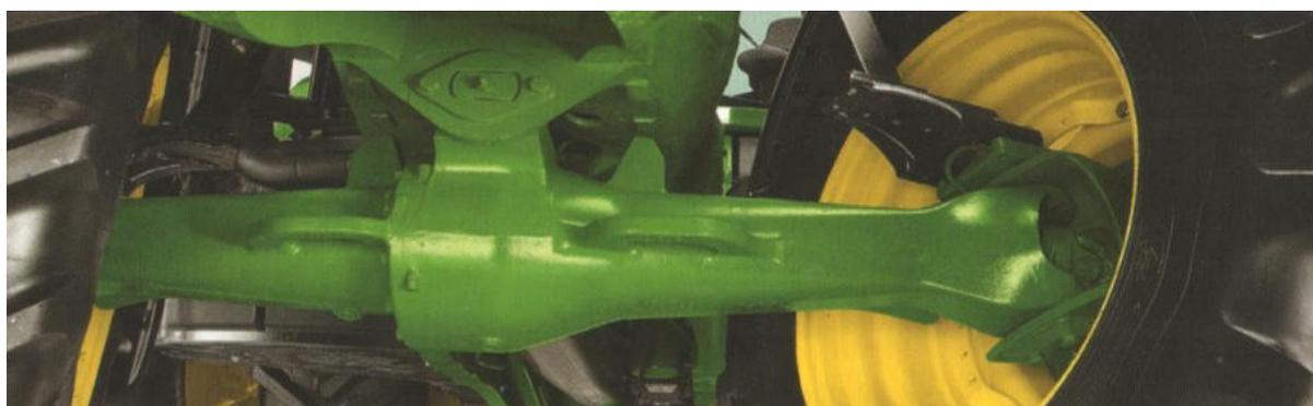
**Рис. 67. Механический привод переднего моста тракторов John Deere серии 1150**
