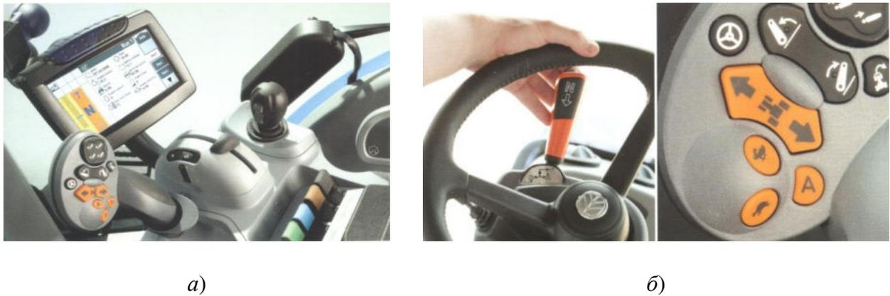
**Рис. 28. Управление трансмиссией в тракторах New Holland T8:**
