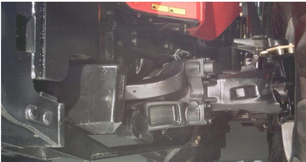
**Рис. 66. Передняя ось MF8400 QuadLink**
