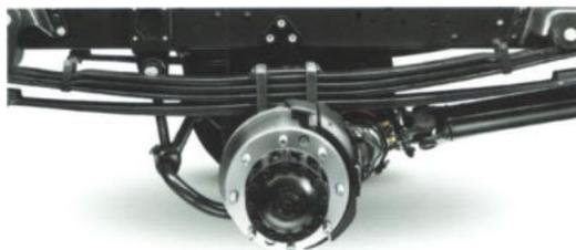
**Рис. 51. Задняя подвеска с параболическими рессорами**
