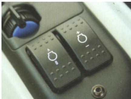
**Рис. 25. Клавишный переключатель числа оборотов коленчатого вала двигателя**
