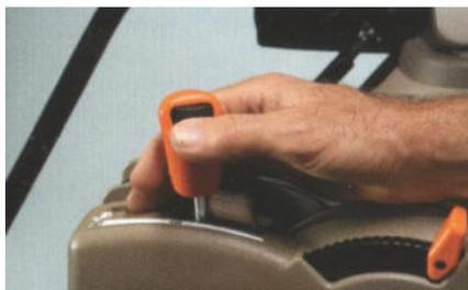
**Рис. 26. Рычаг регулирования скорости**
