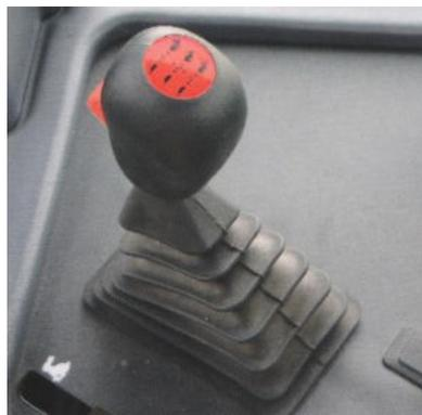
**Рис. 20. Рычаги управления трансмиссией тракторов Versatile серии High Horsepower Tractor**
