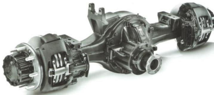
**Рис. 56. Задняя ось для пневмоподвесок**
