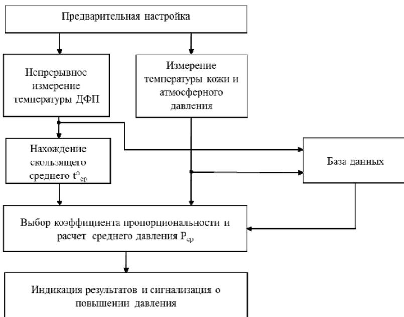
**Рис. 2. Блок-схема программной реализации метода определения артериального давления**
