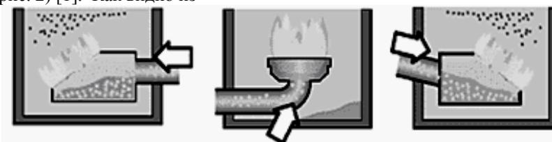
Рис. 1. Схемы подачи гранул в зону горения
