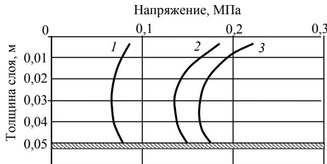
**Рис. 3. Влияние жесткого основания на перераспределение напряжений:**
