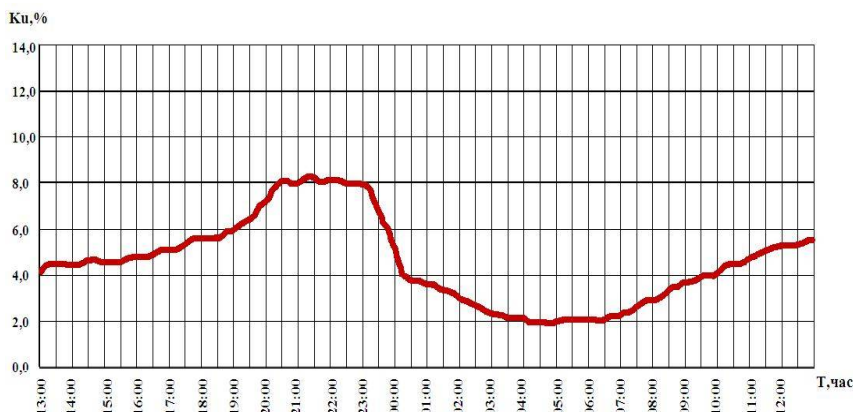
Рис. 1. Изменение коэффициента искажения синусоидальной кривой напряжения
