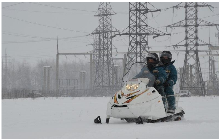
Рис. 1. Использование снегохода для осмотра ЛЭП
