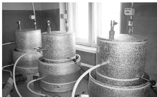
**Рис. 1. Лабораторные биореакторы-метантенки объемом 100 литров для изучения процесса получения биогаза (с. Горелое Тамбовской области)**
