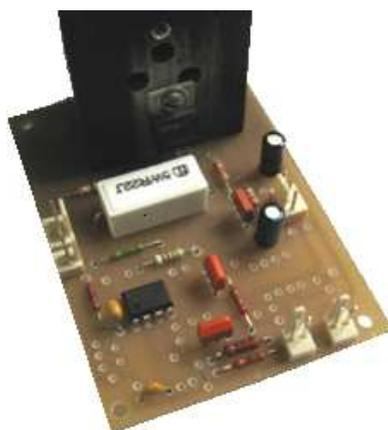
**Рис. 2. Плата контура нагрева измерительной ячейки**
