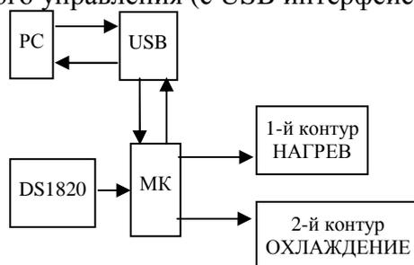
**Рис. 1. Схема установки термостатирования**
