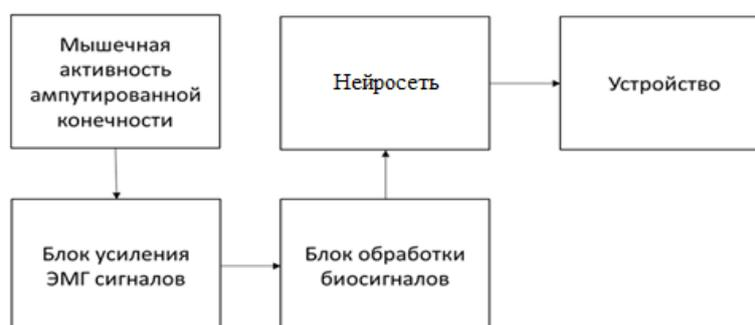
Рис. 1. Структурная схема миоэлектрического протеза кисти
