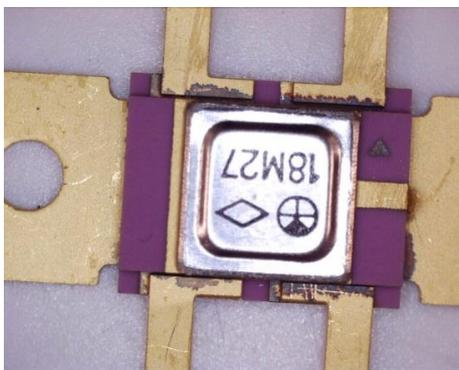
**Рис. 1. Микросхема 142ЕН8А**
