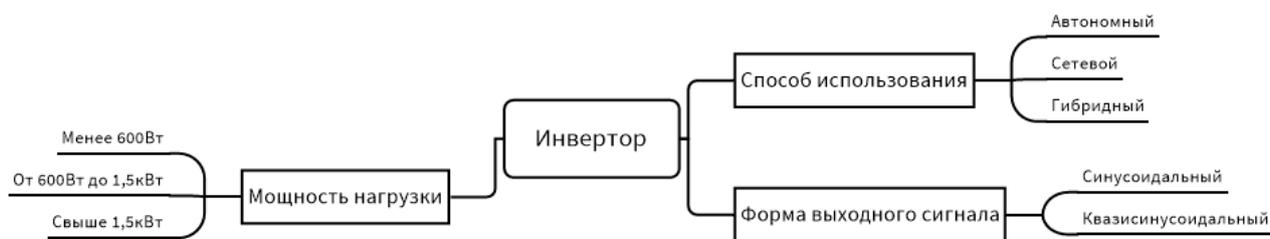
**Рис. 2. Классификация инверторов для систем с ВИЭ**
