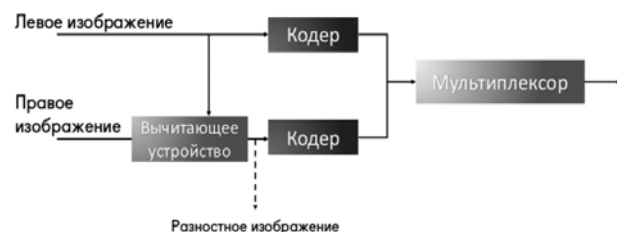
Рис. 2. Передача одного из кадров стереопары и разностного изображения
