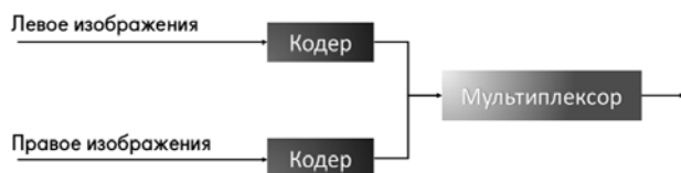
Рис. 1. Схема независимой передачи стереопары
