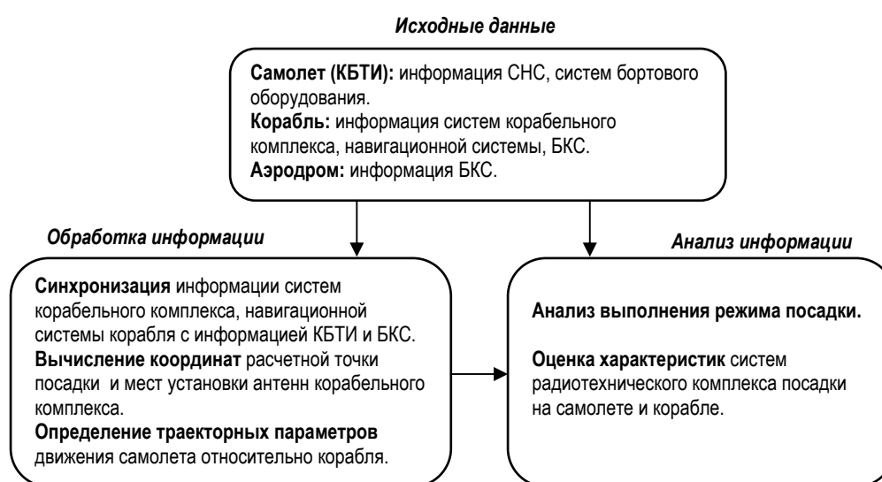
Рис. 8. Структурная схема сбора, обработки и анализа информации при посадке на корабль
