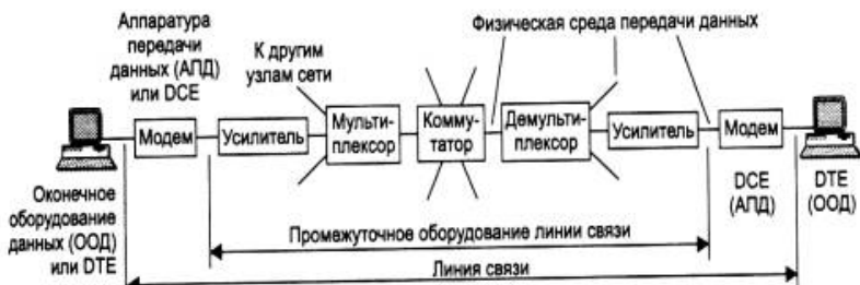
Рис. 1. Состав линии связи
