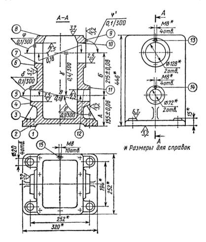
**Пример.** Деталь — корпус цепной коробки скоростей. Все поверхности заготовки этой детали можно обработать, используя в качестве установочной базы поверхность 1, соблюдая, тем самым, принцип единства баз. Поэтому на первой операции следует подготовить эту базу, произведя обработку основания, и две другие базы, в качестве которых целесообразно использовать расположенные по диагонали отверстия 2, предназначенные для крепления коробки передач.
