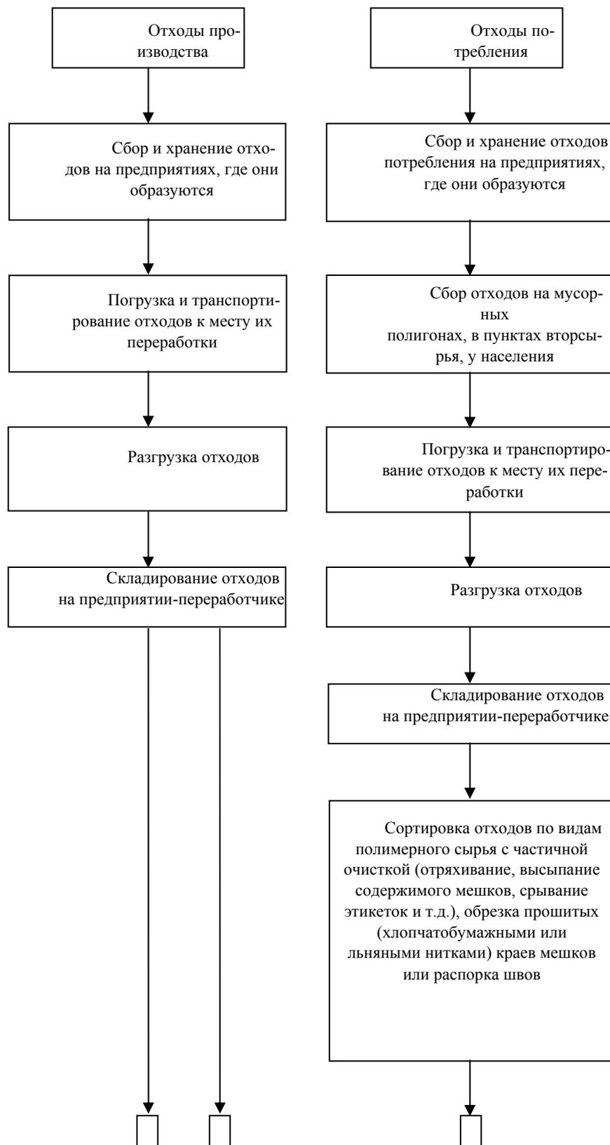
Рис. 2.4. Схема технологического процесса переработки отходов
