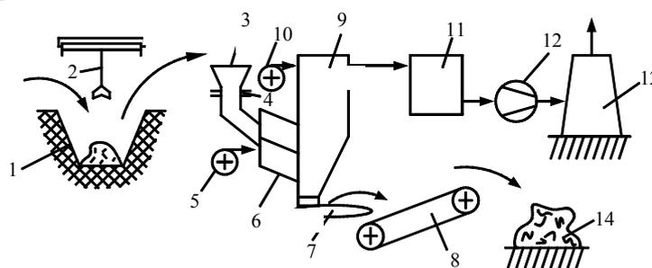
Рис. 2.7. Схема установки термического обезвреживания твердых полимерных отходов
