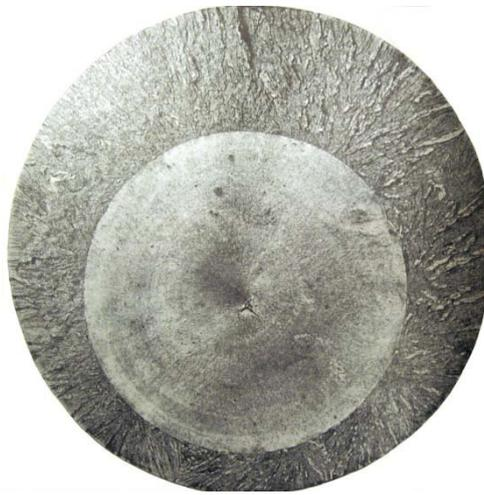
**Рис. 10. Усталостное разрушение стержня поршня (зародыш – ковочная трещина)**
