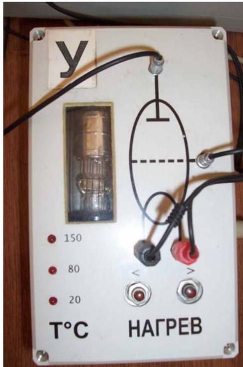
Рис. 7 Внешний вид модуля трехэлектродной лампы
